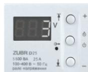
Обратный отсчет всегда будет сопровождаться миганием точки в крайнем правом разряде индикатора при установленном значении 3 с и более 100 с, а при оставшемся времени менее 100 с на индикаторе будет отображаться обратный отсчет в секундах до включения нагрузки.
