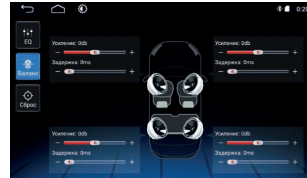
Настройка временных задержек
