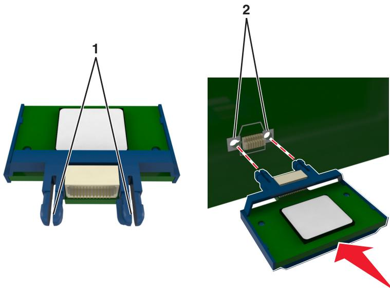
4 С усилием вставьте плату в разъем, отображенный на иллюстрации.
