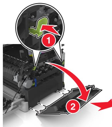
5 Нажмите на зеленые рычаги с обеих сторон емкости для отработанного тонера и извлеките ее.
