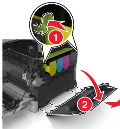
**5** Нажмите на зеленые рычаги с обеих сторон емкости для отработанного тонера и извлеките ее.
