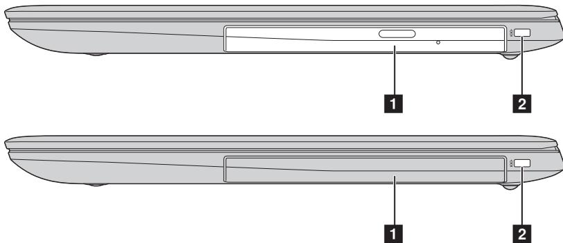
**1 Привод оптических дисков (в некоторых моделях)**
