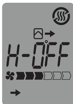
Рисунок 5. Индикация «Нагреватель выключен»
