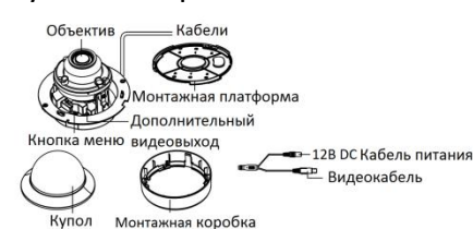
Рисунок 1-14 Купольная камера III типа
