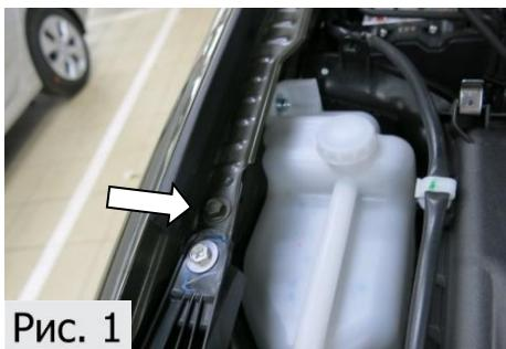
2. Установить болт-шарнир с шайбой 6. Затянуть болт-шарнир удлиненной торцевой головкой №10 с усилием 9 Нм, (Рис.2).
