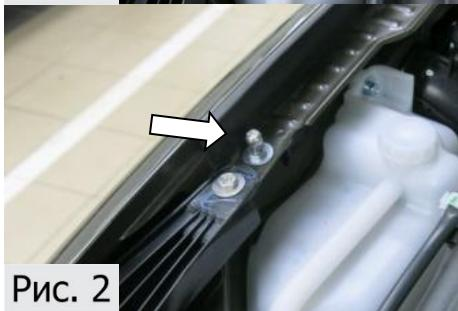
3. Открутить верхнюю гайку крепления капота торцевой головкой №12,(Рис. 3).
