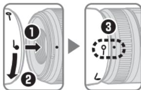
Rikta upp motljusskyddets låsmarkering (—○) med motljusskyddets monteringsmarkering (●) på objektivet (3).
