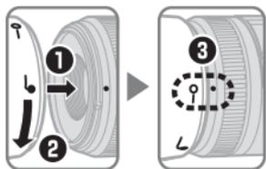
将镜头遮光罩锁定标记（—○）与镜头上的镜头遮光罩安装标记（●）对齐（③）。
