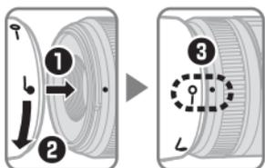
Alinhe a marca de bloqueio do pára-sol da objectiva (—○) com a marca de montagem do pára-sol da objectiva (●) na objectiva (③).
