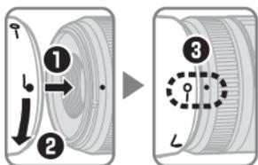
*Alinhe a marca de trava do para-sol da lente (—○) com a marca de fixação do para-sol da lente (●) na lente (3).*
