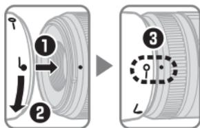
Zarovnajete značku aretovanej polohy slnečnej clony objektívu (—○) s upevňovacou značkou slnečnej clony objektívu (●) na objektíve (3).
