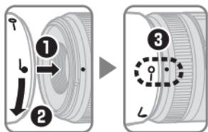
*Alinee la marca de bloqueo del parasol (—○) con la marca de montaje del parasol (●) en el objetivo (3).*
