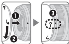
Lijn de vergrendelmarkering op de zonnekap (—○) uit met bevestigingsmarkering voor de zonnekap (●) op het objectief (③).
