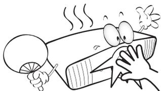
6. В некоторых странах напряжение сети нестабильно. Проектор рассчитан на безопасную работу при напряжении в сети от 100 до 240 В переменного тока, но отключение питания или скачки напряжения  $\pm 10$  В могут привести к его неисправности. **Поэтому в регионах, где возможны сбои питания или скачки напряжения, рекомендуется подключать проектор через стабилизатор питания, сетевой фильтр или источник бесперебойного питания (ИБП).**
