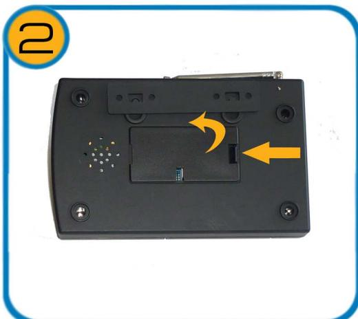
Возьмите контрольную панель и откройте отсек, закрывающий держатель SIM-карты. Для этого слегка надавите на выступающий замок крышки и потяните крышку вверх.
