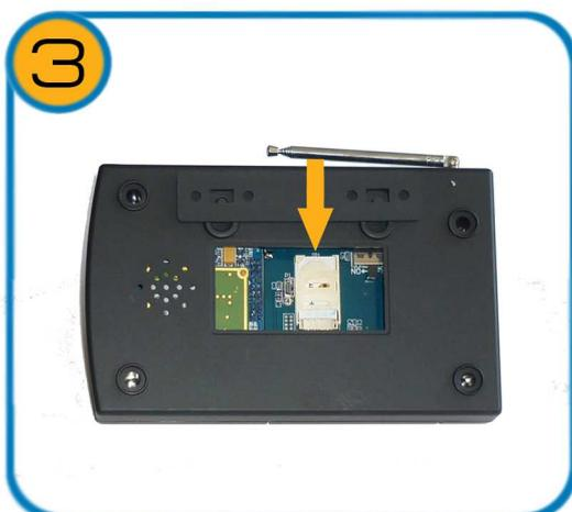
Вставьте SIM-карту в держатель. Подробно прочитать как это сделать можно в пункте инструкции **«Включение контрольной панели»**
