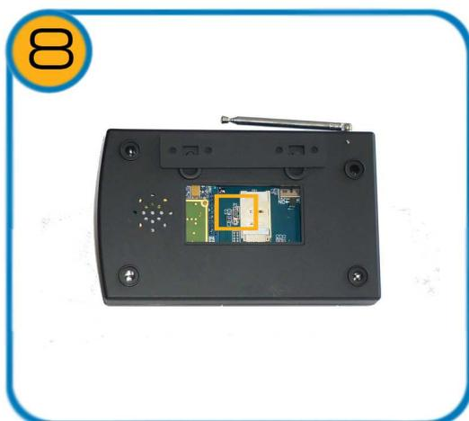
Подключение КП Sapsan GSM PRO5T производится с использованием кабеля USB-miniUSB, идущего в комплекте. Разъем для подключения находится левее держателя для SIM-карты.
